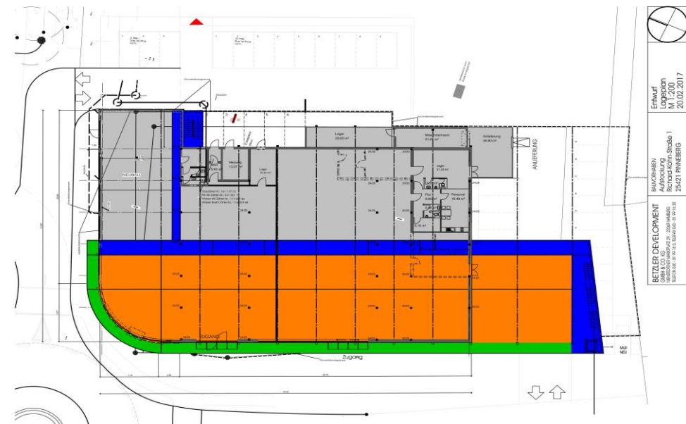
Beispiel: Begrünter Modulbau auf vorhandener Dachfläche
